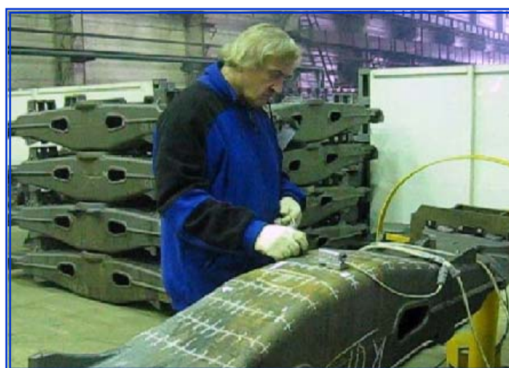
Рис. 5 Проведение контроля на действующем производстве завода-изготовителя нижнего пояса надрессорной балки тележки 18-100 лазерным комплексом «ПСК» с ручным вариантом перемещения электромеханического ударника.
